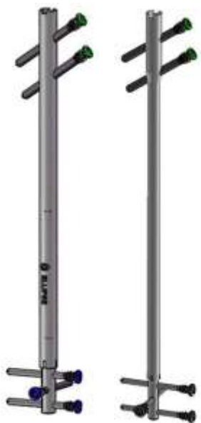
Klin Precice IMLL sa zaključavajućim zavrtnjima (10,7 mm levo, 8,5 mm desno)
