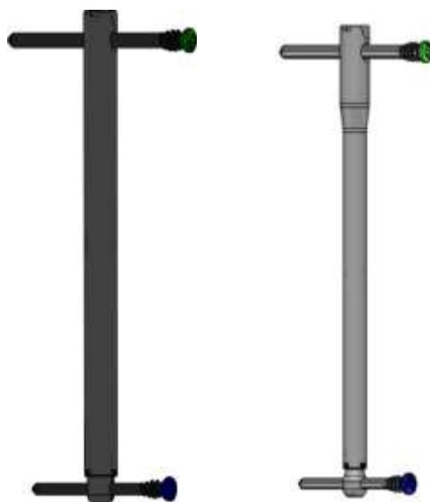
Chiodo Precice-S IMLL Gen 2 con viti di bloccaggio (10,7 mm a sinistra, 8,5 mm a destra)
