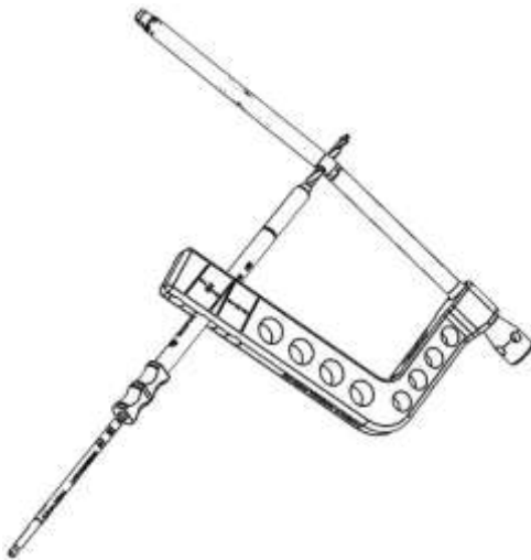
Precice-S IMLL -naulan malli P – retrogradinen reisiluu, kaarevuus 10°
