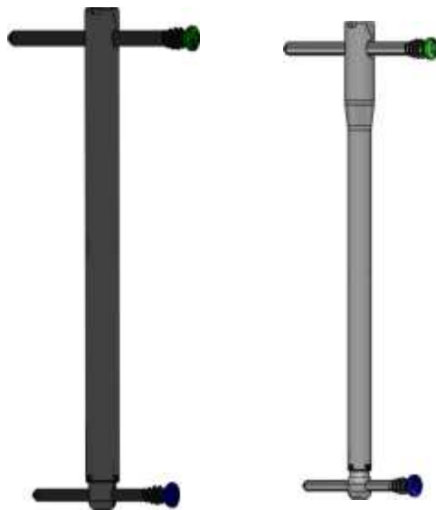
Precice-S Gen 2 Nagel mit Spannschrauben (10,7 mm links, 8,5 mm rechts)
